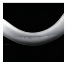
配管酸化物検査
