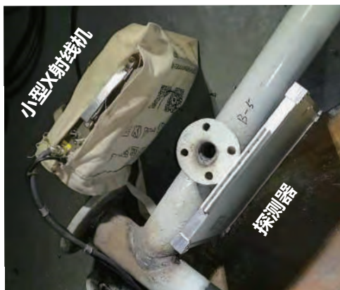
输油配管内部检测实例
