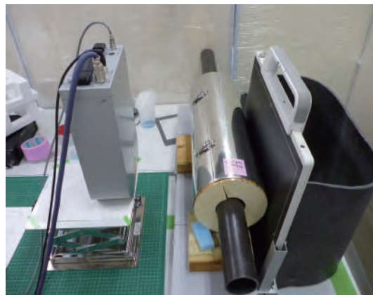
附着保温材的配管检测实例
