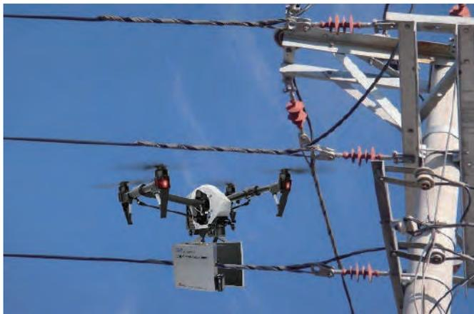
ドローンと組み合わせて、遠隔制御撮影を実現し、リアルタイムで検査結果を観察できる
